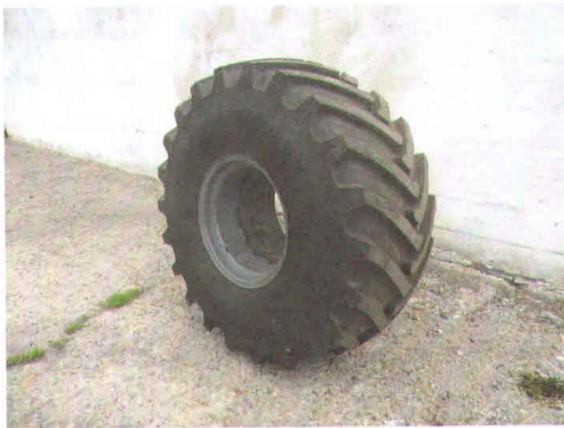
Рисунок 2 - Шина пневматическая 28,1 R26 158 A8 модели ФД-12М, установленная на ободу DW 24×26. Общий вид
