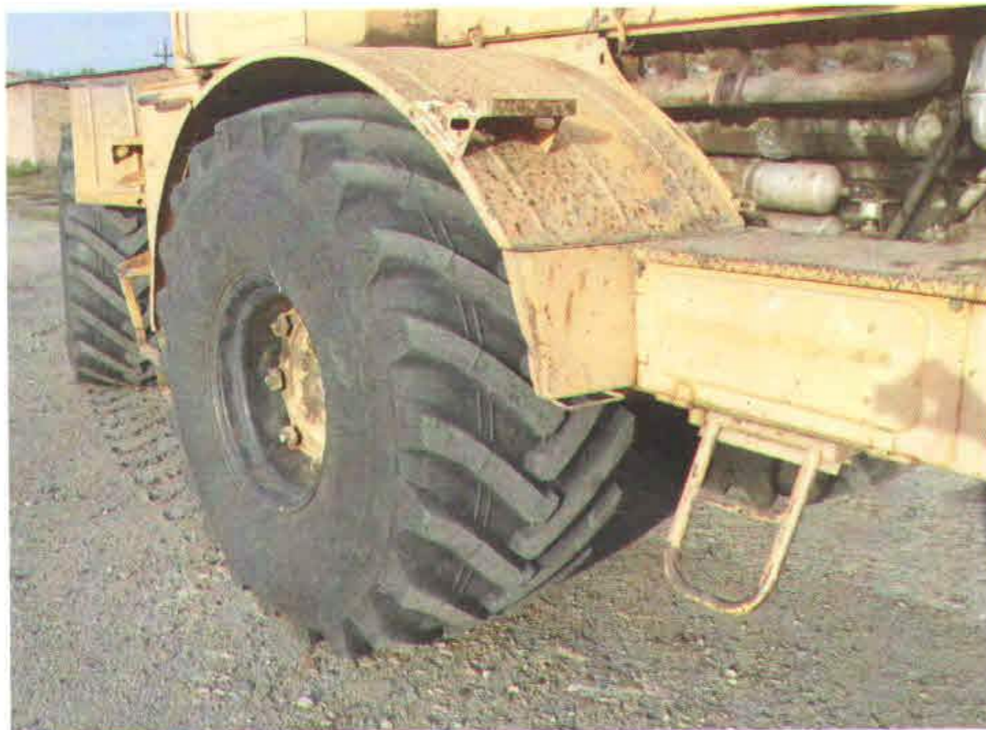
Рисунок 1 - Шина пневматическая 28,1R26 158 A8 модели ТА-02, установленная на тракторе К-701. Общий вид
